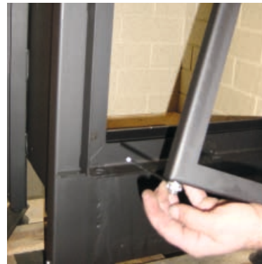
5. Spannschlüssel mit dem Griff nach außen neu ansetzen (ca. 180° nach links – bei Linksanschlag)
